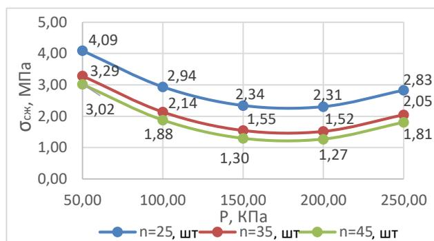
Рисунок 6 График зависимости  $\sigma_{сж} = f(P, n)$  при  $\psi=70\%$  и  $H=30$  мм
